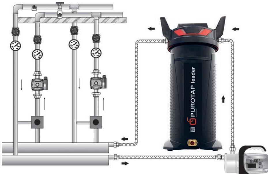
Dabei wird der Ionentauscher mit Hilfe einer separaten Pumpe (z.B. Jetpumpe, Impellerpumpe, Kreiselpumpe) und 2 Panzerschläuchen in die Hauptzirkulation der Heizungsanlage eingebunden. Es ist hierbei weniger von Bedeu-
