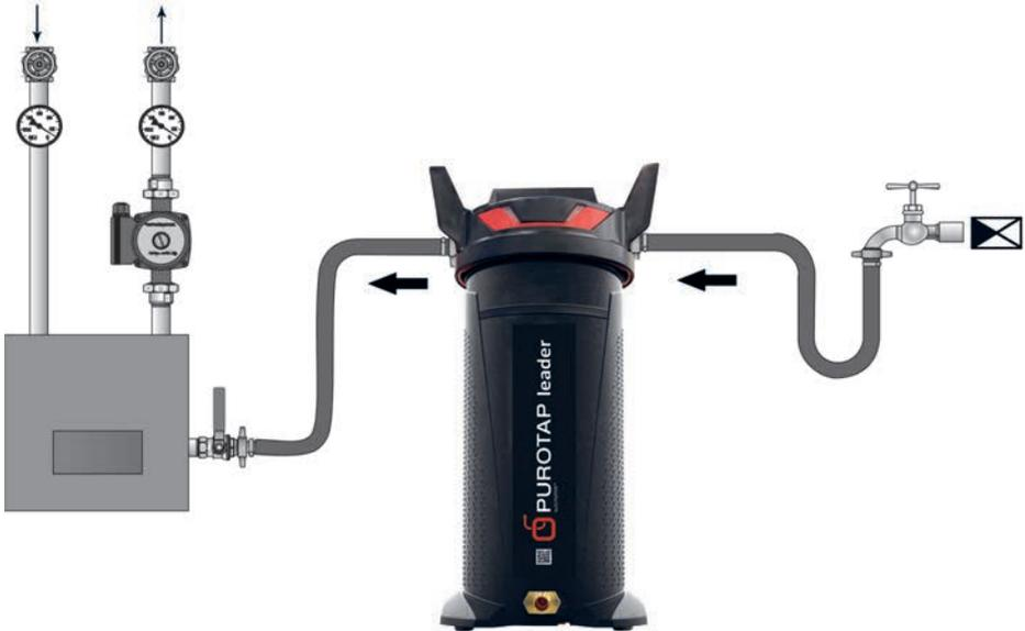
Diese Anschlussvariante eignet sich, um Heizungen mit demineralisiertem Wasser zu füllen.
