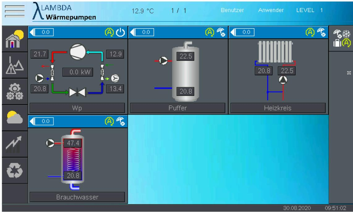
Innerhalb der Modulübersicht sind die einzelnen, konfigurierten Softwaremodule erkennbar. In diesem Fall beinhaltet die Heizungsanlage eine Wärmepumpe, einen Heizungspuffer, einen ungemischten Heizkreis und einen Brauchwasserspeicher. Je nach Hydrauliksystem können Softwaremodule vom Fachmann erweitert, geändert, oder reduziert werden. Jedem Modul kann ein Individueller Name zugeteilt werden.
