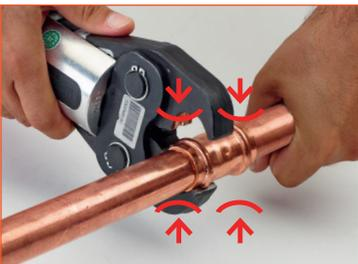
7) **Das verpresste Fitting garantiert die mechanische Festigkeit** der Anlage sowie perfekte Dichtung durch den O-Ring.
