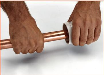
2) **Das Rohrende vorsichtig entgraten.** Restliche Grate können die O-Ringe beschädigen und die Dichtheit der Verbindung beeinträchtigen.
