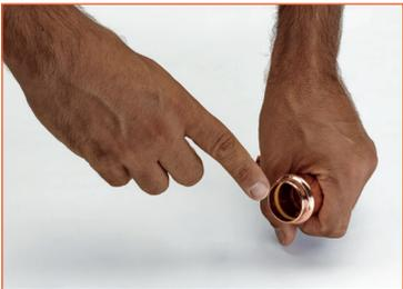
3) **Überprüfen Sie die korrekte Position des O-Rings.** Um die Einführung des Rohrs zu vereinfachen, können Sie den O-Ring mit einer Lösung von Wasser und Seife befeuchten. Vermeiden Sie unbedingt die Verwendung von Öl oder Fett.
