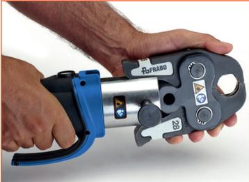
5) **Rüsten Sie die Pressmaschine mit der Backe aus**, die dem Durchmesser und dem Profil (V) des zu verbindenden Fittings entspricht.
