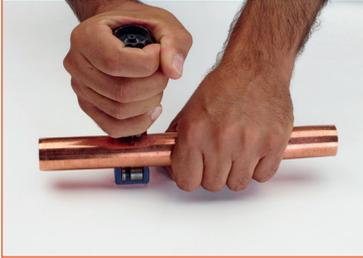
1) **Schneiden Sie das Rohr** auf die gewünschte Länge. Vermeiden Sie die Verwendung von Geräten, bei denen die Gefahr einer Verformung besteht. Zum Beispiel ist es wichtig, das Schneiden mit Bügelsägen oder die Verwendung von Scheibenrädern zu vermeiden.
