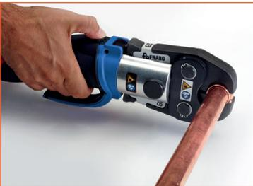
6) **Positionieren Sie das Presswerkzeug** so, dass die Ringkammer des Fittings richtig in der Pressbacke sitzt. Verpressen Sie die Verbindung, bis beide Halbbacken in Kontakt kommen.
