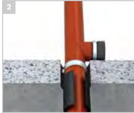
Die Länge des ROKU® Strip L_w je nach Rohrdurchmesser bzw. Verbindenumfang ablängen. Das ROKU® Strip L_w muss nur einlagig um das Rohr verlegt werden.
