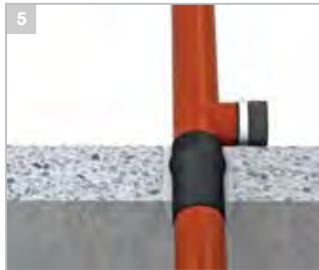
Streifen fest andrücken und alle Restfugenspalten mit z. B. Mörtel oder Beton füllen.
