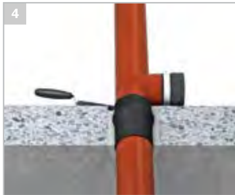
Streifen mit fixer Höhe von 250 mm durch die Decke führen.
