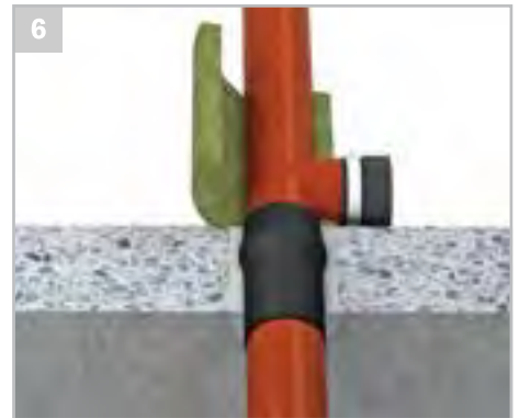
Steinwollisolierung mit 30 mm Dämmdicke einlagig auf einer Bauhöhe von 10 cm bzw. 30 cm je nach Durchmesser des Rohres aufbringen und Abschottung kennzeichnen.
