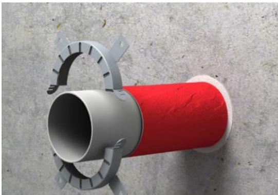
3. Manschette mit Dübeln oder Stahlschrauben M6 / M8 an Wand / Decke bzw. mit Gewindestangen M6 / M8 an leichter Trennwand befestigen. Alle vorhandenen Befestigungspunkte nutzen.
