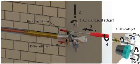
Drei Bohrungen je ø8mm setzen und mit Dübel versehen. Von der Anschlussseite erst die Rosette und dann den Flansch aufschieben. Die Armatur wie oben gezeigt in die Wand einführen und den Flansch mit der flachen Seite an der Wand fixieren.
