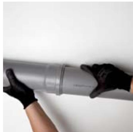
Ein für Temperaturschwankungen geeignetes System: Die **Wärmeausdehnung von Valsir PP ist gegenüber anderen gebräuchlichen Kunststoffen äußerst gering**. Ein 3 m langes Rohr dehnt sich bei einem Abwasserfluss mit einer konstanten Temperatur von 60°C lediglich um 13 mm in der Länge aus.
