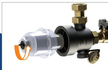
3. Den Verschluss des Magnets mithilfe eines 29-mm-Inbusschlüssels gegen den Uhrzeigersinn abschrauben. Achten Sie darauf, dass das Wasser in einem passenden Behälter aufgefangen wird.
