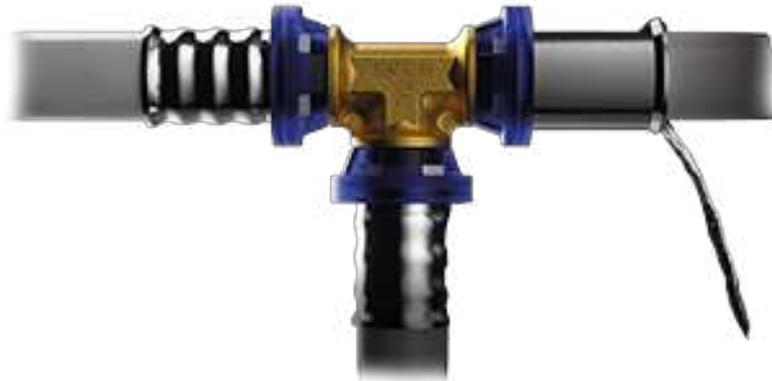
Die LBP-Funktion garantiert eine schnelle und sichere Installation von Pressfittingen, da Flüssigkeit dort entweichen kann, wo die Verbindungsstelle nicht angemessen gepresst wurde.
