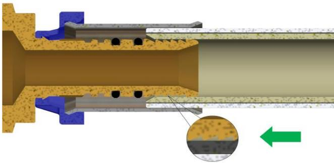
Der vordere ist so konzipiert, dass er das Einführen des Fittings in das Rohr erleichtert (einfaches Drücken).
