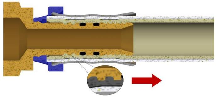
Der hintere Teil ist mit speziellen Rillen versehen, um die Dichtheit zwischen dem Kunststoffrohr und dem Metallbeschlagteil zu gewährleisten.
