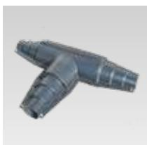
Der Isoliersatz für T-Verbindungen garantiert die vollständige Isolierung und Abdichtung von Abzweigungen. Der Doppel T-Isoliersatz wird bei Abzweigungen von single auf double Rohren eingesetzt. Die Isoliersätze bestehen aus zwei HDPE-Halbschalen, Edelstahlschrauben und einem Schmiermittel gegen das Kaltverschweißen der Schrauben. ACHTUNG: nicht vergessen das gewünschte Dämmpaket mitzubestellen!
