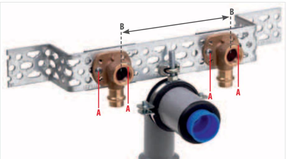
Montage der Wandwinkel im Längsloch (A) ermöglicht problemloses Verschieben im Bereich (B) von 146 - 173 mm
