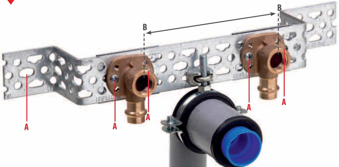
Beispiel - Stichmaß 153 mm: Montage der Wandwinkel im Längsloch (A) ermöglicht problemloses Verschieben im Bereich (B) von 146 - 173 mm
