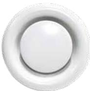
Aus verzinktem Stahlblech und in RAL 9010 pulverbeschichtet. Der Ventilkörper ist mit einer Schaumstoffdichtung ausgestattet. Durch den großen Einstellbereich ist das Ventil besonders für Büroräume geeignet. Es wird durch Verdrehen am Einbaurahmen montiert. Die Luftmengenregulierung erfolgt durch das Verdrehen des Ventiltellers. Die benötigte Position wird durch eine Kontermutter fixiert. Max. Luftmenge 50 m<sup>3</sup>/h.
