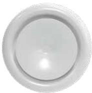
Aus verzinktem Stahlblech und in RAL 9010 pulverbeschichtet. Es zeichnet sich durch einen niedrigen Geräuschpegel, große Wurfweite mit hoher Induktion und somit eine zugfreie Luftverteilung aus. Die abnehmbare Frontplatte erleichtert das Reinigen, Messen und Einstellen des Ventils und der Anschlussstutzen ermöglicht einen luftdichten Übergang zum Luftleitungssystem. Max. Luftmenge 50 m<sup>3</sup>/h.
