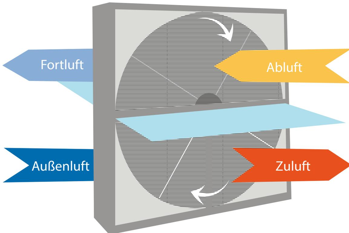
Das Herzstück der KWL-„R“-Geräte ist der Rotationswärmetauscher: Bei dieser Technik dreht sich ein Rotor, der aus zahlreichen Kanälen parallel zur Drehachse besteht. Das Aussehen ist Wellpappe ähnlich, jedoch aus korrosionsbeständiger dünner Aluminiumfolie mit hygroskopischer Beschichtung.
