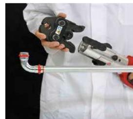
Abhängig von der Dimension des Pressfittings ist die zugehörige Pressbacke in das Pressgerät einzusetzen bzw. die passende Pressschlinge/-kette auf dem Formteil zu montieren. Die Nut der Pressbacke/-Pressschlinge/-kette muss genau über der Pressfittingwulst des Formteils positioniert sein. Nach dem Verpressen ist die hergestellte Verbindung auf korrekte Ausführung und Einhaltung der Einstecktiefe zu prüfen.
