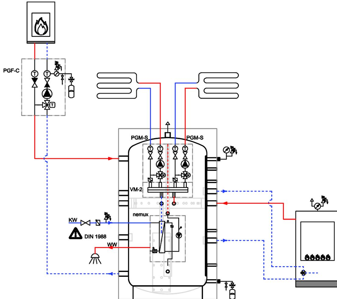
*Beispiel Brennwert mit Umschaltung im Rücklauf und Biomasse-Wärmeerzeuger*
