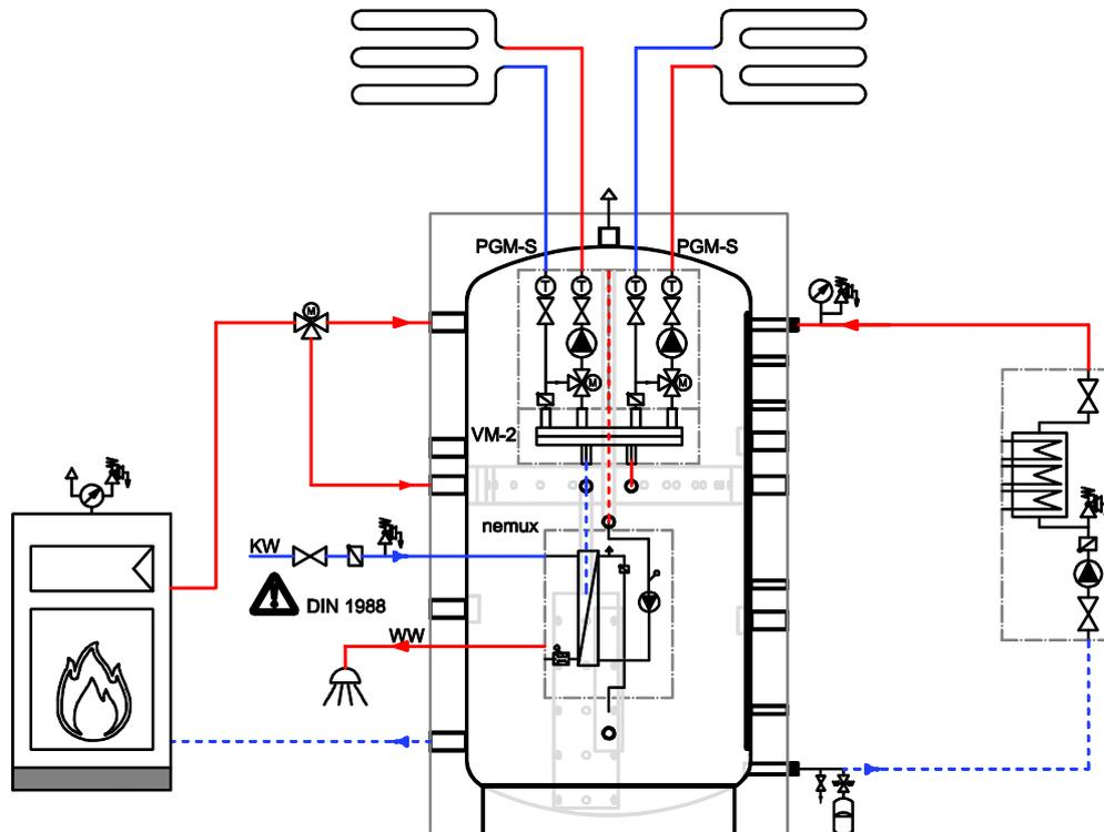
Beispiel Pelletkessel mit Umschaltung im Vorlauf und Power-to-Heat mit e-therm
