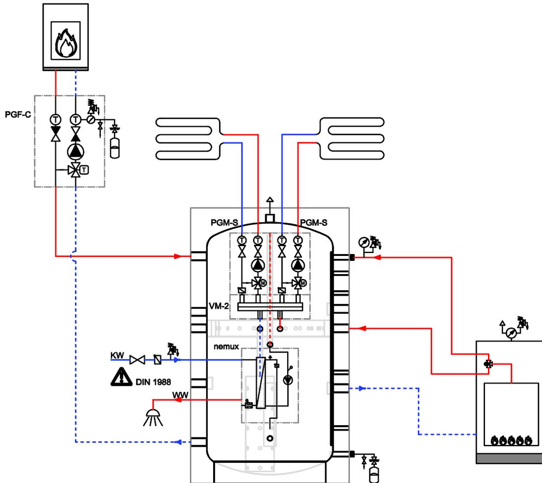
Beispiel Brennwert mit Umschaltung im Vorlauf und Biomasse-Wärmeerzeuger.
